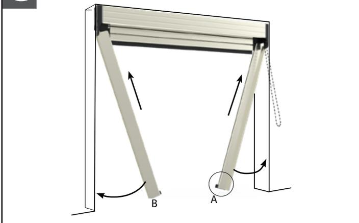
**D** Forare e fissare con viti e tasselli in dotazione all'interno delle guide
