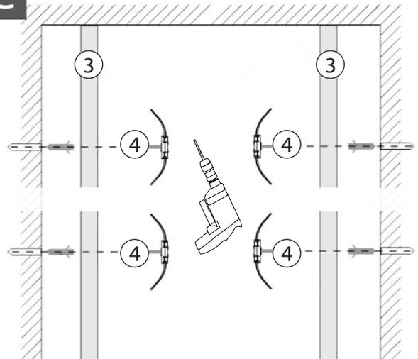
Inserire lateralmente i sistemi di fissaggio (4) sui compensatori laterali
