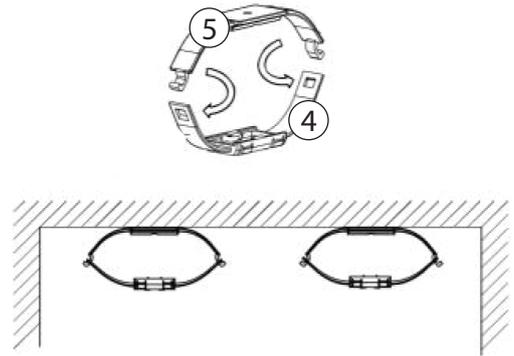
Inserire i sistemi di fissaggio del cassonetto nella parte superiore del vano (4 - 5)
