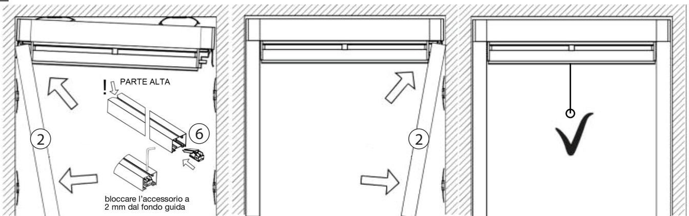
Bloccare l'accessorio (6) nella parte alta delle guide e fissare le guide laterali (2) sui sistemi di fissaggio posizionati precedentemente sui compensatori laterali. Per il movimento di apertura e chiusura inserire corda e nappino di manovra. (7-8)
