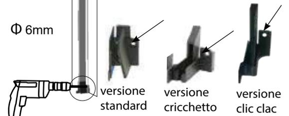
**A** Posizionare le contropiastre nel vano, forare e fissare con i tasselli e viti in dotazione, nei 4 punti indicati in figura.
