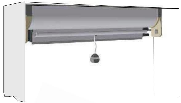
**E** Inserire i compensatori delle guide sui due lati del vano, forare e fissare con viti e tasselli in dotazione nei punti indicati in figura "e"
