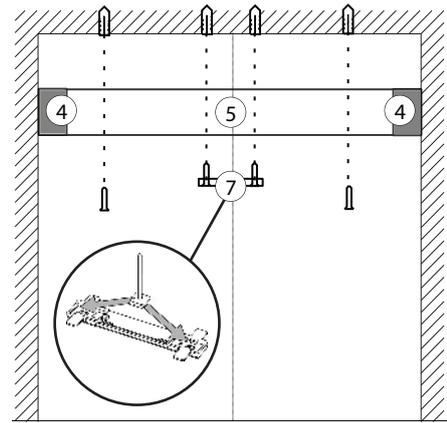
Inserire le cuffie (4) nel compensatore (5) e fissarlo con viti e tasselli nella parte superiore del vano dopo di che inserire il blocca guide (7) nella parte centrale dei due compensatori.
