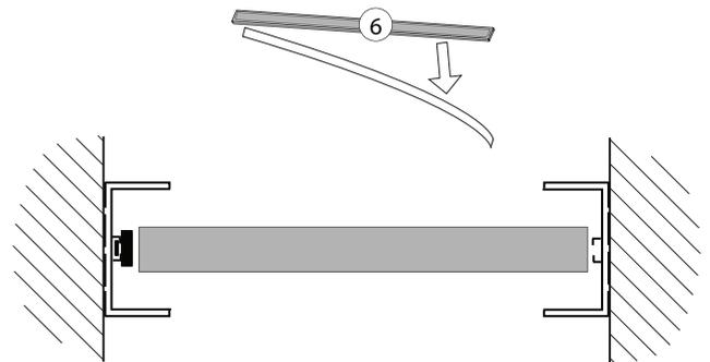
Fissare la guida a terra con il bioadesivo nella parte inferiore del vano curando di mantenere la verticalità con la guida superiore.
