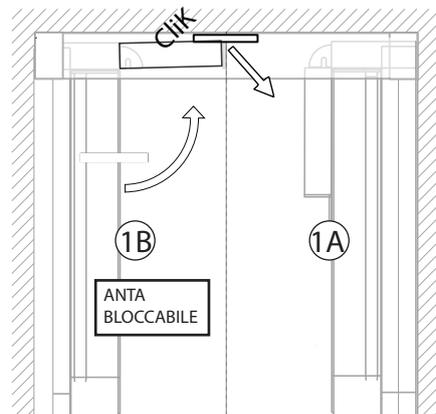
Sganciare la guida dell'anta bloccabile e bloccarla sulla parte superiore del compensatore fino sentire un klik di avvenuto fissaggio.
